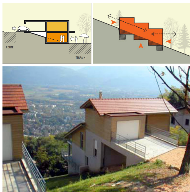
Schémas de principes «Construire dans la pente» Source : CAUE73
