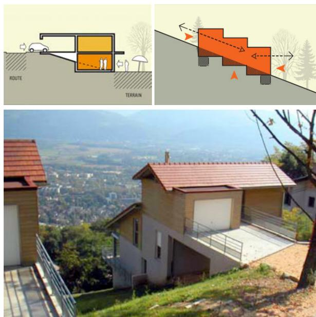
Schémas de principes «Construire dans la pente»
