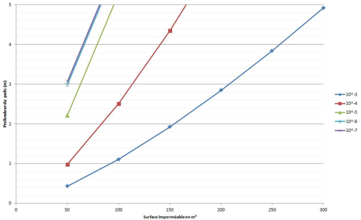
Figure 4 : dimensionnement puits d'infiltration DN2000 - T30ans
