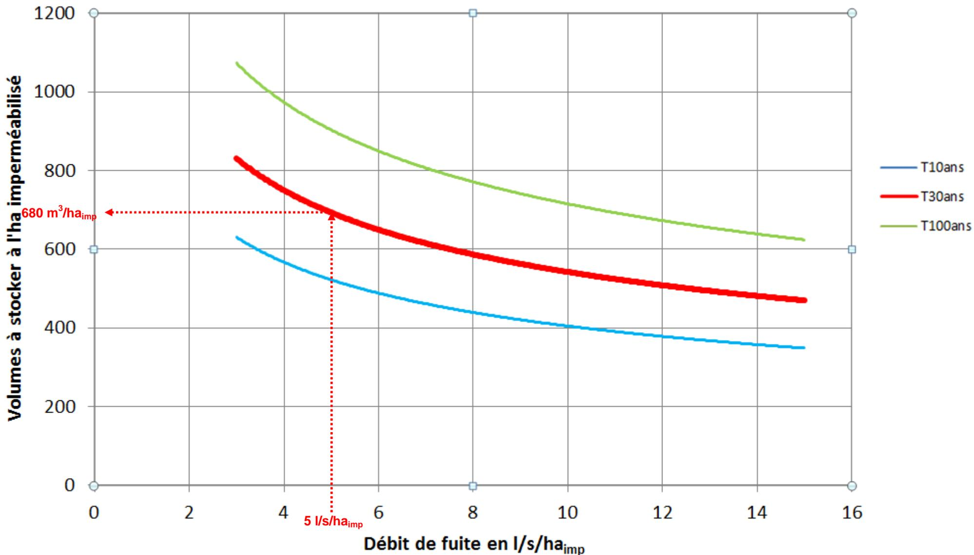
**Exemple :** aménagement d'une zone d'activité sur 1,3 ha. Imperméabilisation de 60% de l'emprise totale, soit 7 800 m<sup>2</sup> imperméabilisés (0,78 ha).
